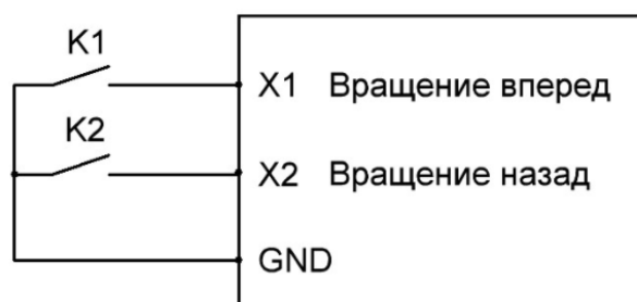
Рис. 5-11 Принципиальная схема двухпроводного режима работы
